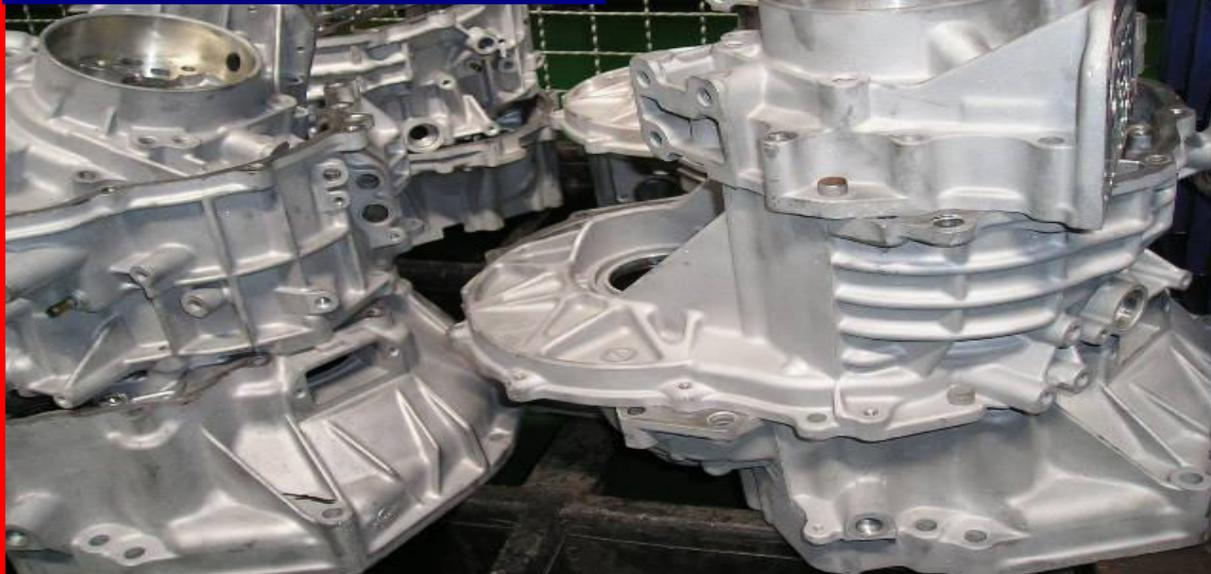
變速箱之零組件重新組裝校正，再作壓力測試及油密檢查，以符合變速箱之安全需求。
