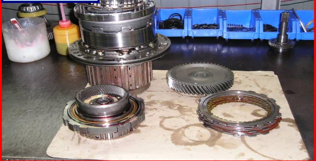
將自動變速箱內部各項零組件(制動帶、離合器、油封、墊片等)，作細部之完全分解。
