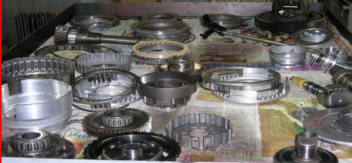
依各項零件組件狀態作精密之點檢，並完成各閥體之壓力測試，確認閥體之結構性及功能性，以完成安全測試。
