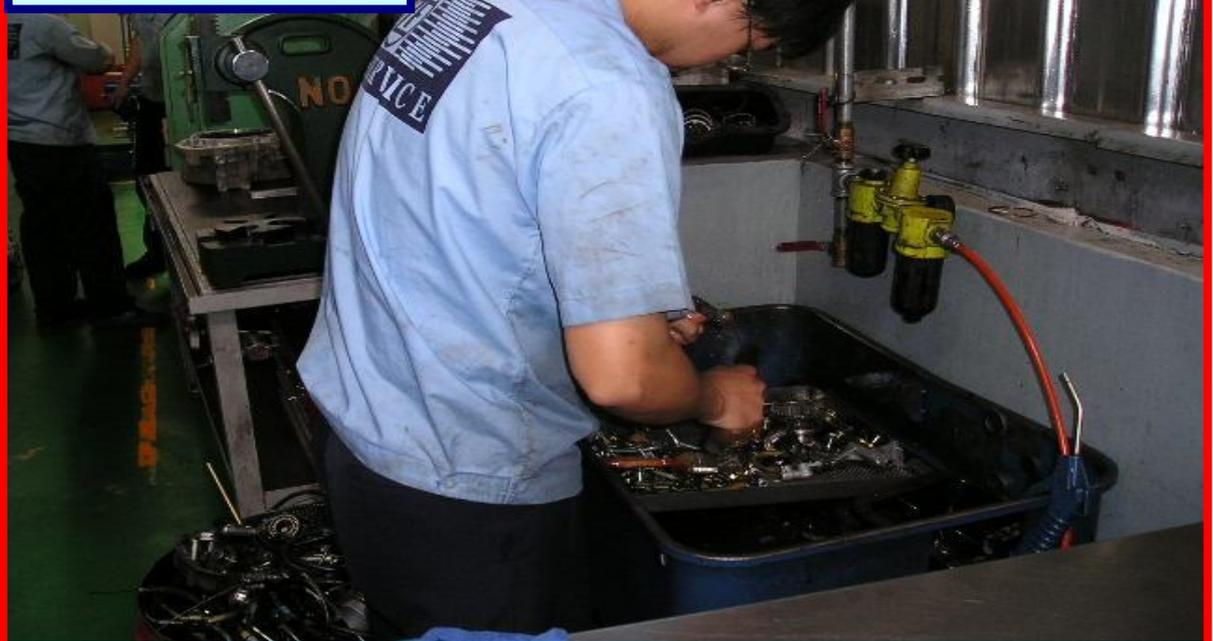
利用高週波高溫零件清洗機，將分解的自動變速箱零組件作油泥之徹底清除。
